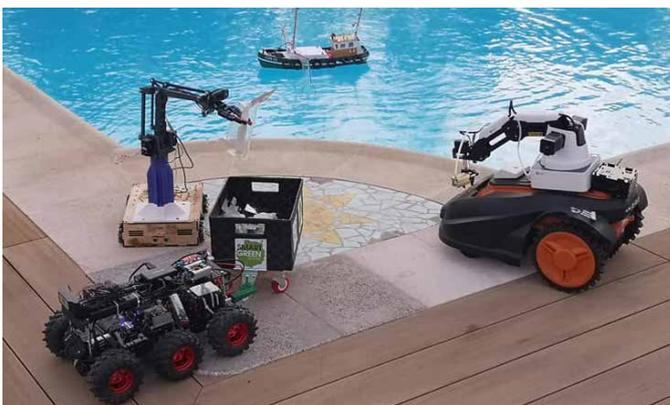
Mit dem weiterentwickelten Roboter "roBottle" wurde ein neuer mobiler Roboter entwickelt, der bereits vorhandenen und unsachgemäß entsorgten Müll z. B. am Strand oder im Wald autonom einsammelt. Darüber hinaus nutzt der mobile Roboter moderne Infrastruktur und IoT-Technologien, um mit Hilfe von Künstlicher Intelligenz (KI) autonom und effizient zu handeln. Algorithmen der Künstlichen Intelligenz sorgen dafür, dass der Roboter die Umgebung wie ein Mensch
